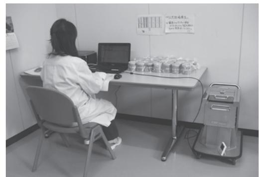
NAI シンチレーションスペクトロメータによる牧草の放射線検査
