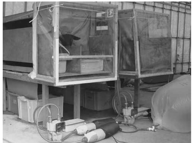
図 4-3. 本研究室で開発したヘッドチャンバーによるメタンガス放出量を測定する呼吸試験装置
